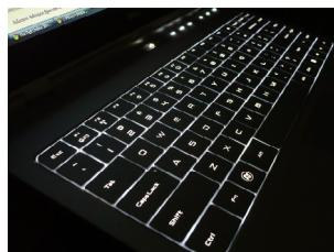
Pozadinsko svjetlo tipkovnice na Dell prijenosnim računalima ima drugačija stanja osvjetljenja. Pritiskom Fn i desne tipke strelice se prebacuje između tri stanja osvjetljenja.
